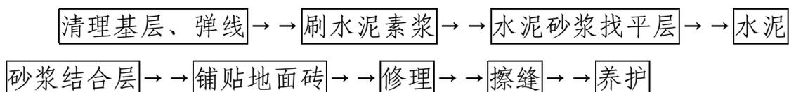
(2) 清理基层、弹线：将基层清理干净，表面灰浆皮要铲掉、扫净。将水平标高线弹在墙上。
