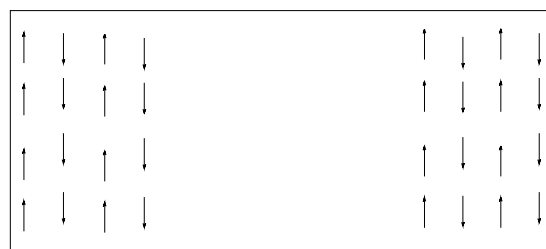
汽机基础砼浇注方向示意图
