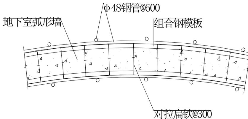
图 5-14 地下室弧形墙模板平面示意图
