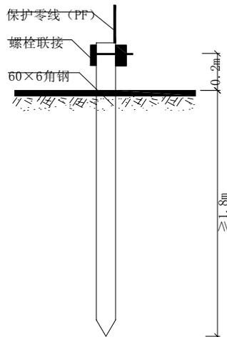
图 10-8 保护接地连接示意图
