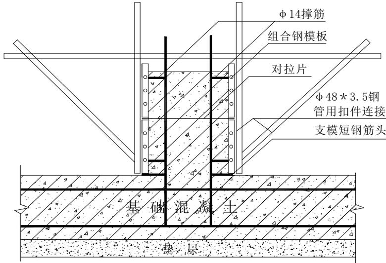
图 5-10 基础梁混凝土模板
