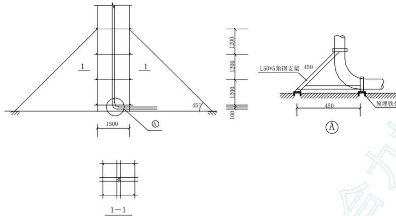
图 5-27 泵管固定示意图
