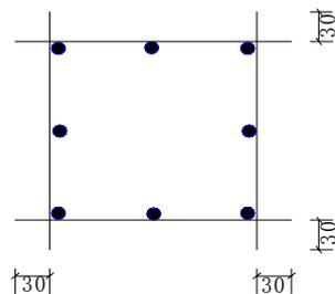
图 5-5 柱筋保护层示意图
