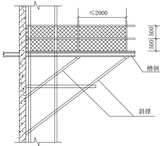
图 10-5 卸料平台防护示意图
