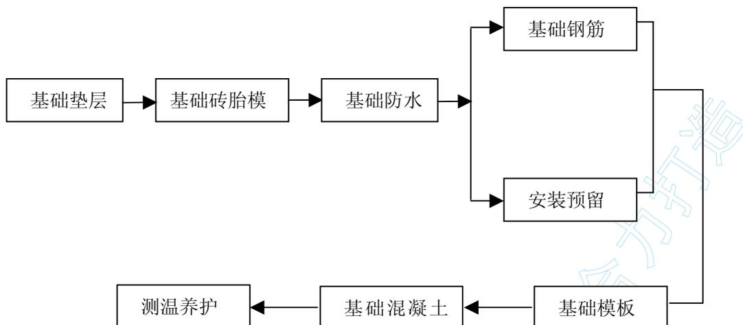
图 3-3 基础施工流程
