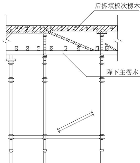
图 5-26 拆模方法示意图
