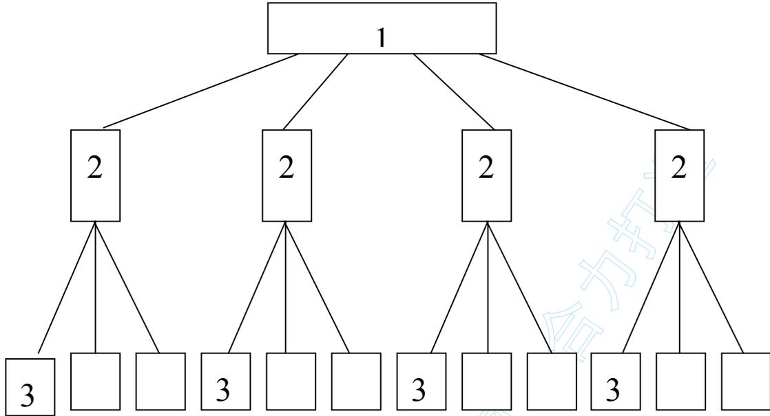
图 10-7 三级配电二级漏电保护系统示意图
