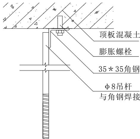
图 6-1 吊杆与顶板的连接
