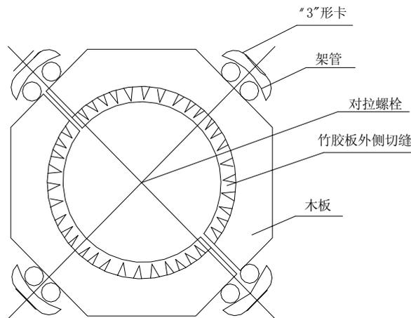
图 5-12 圆柱模支设示意图
