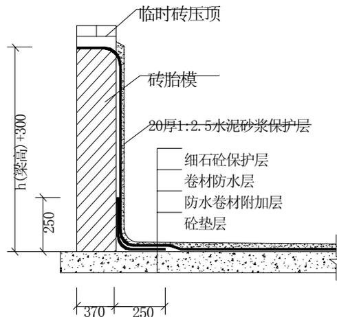
图 5-2 底板外防水砖胎模做法图
