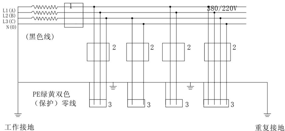
图 10-6 TN-S 接零保护系统示意图
