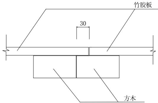
图 5-17 模板拼缝节点
