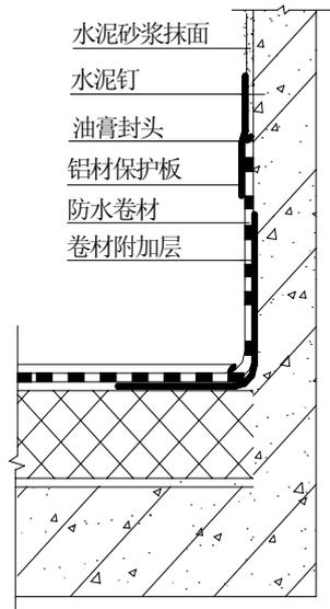
图 7-1 女儿墙泛水构造示意图
