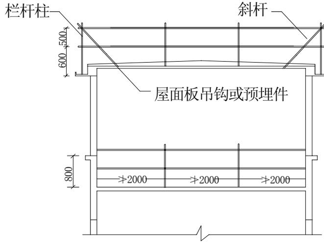
图 10-2 四口、五临边防护示意图
