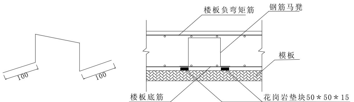
图 5-7 钢筋马凳示意图
