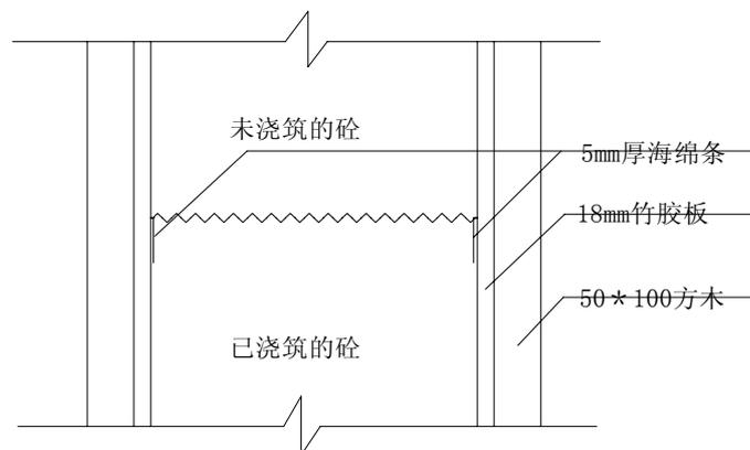
图 5-16 墙体水平施工缝支模
