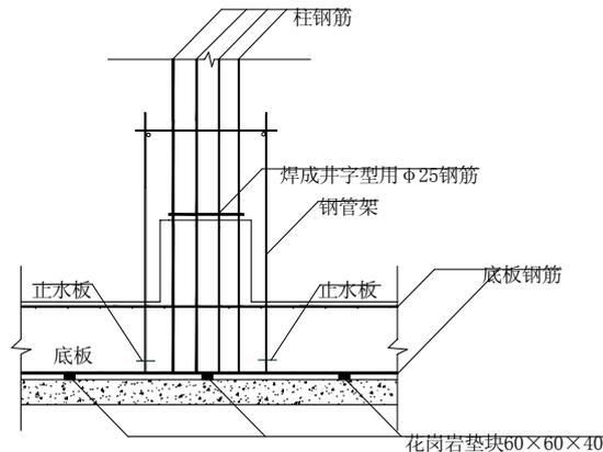
图 5-4 底板柱插筋固定示意图
