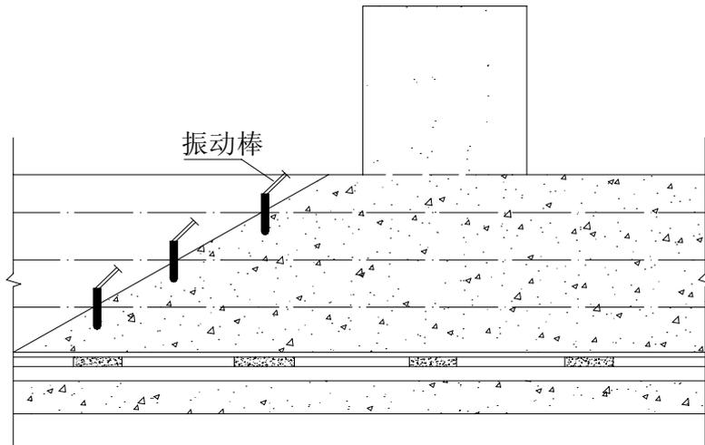
图 5-28 基础底板大体积混凝土振捣示意图
