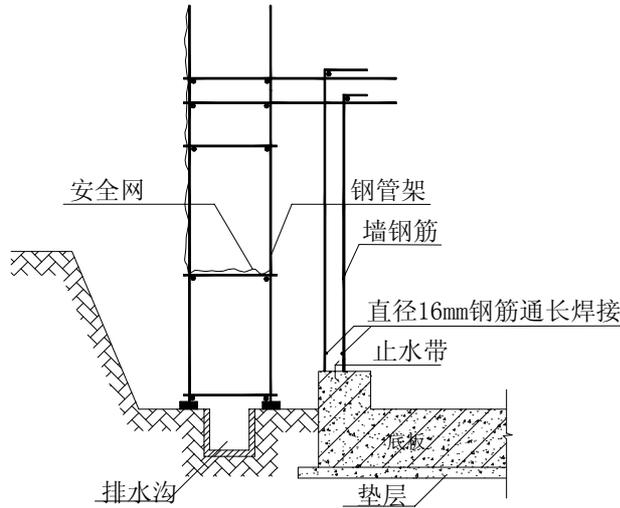
图 5-6 墙钢筋定位图
