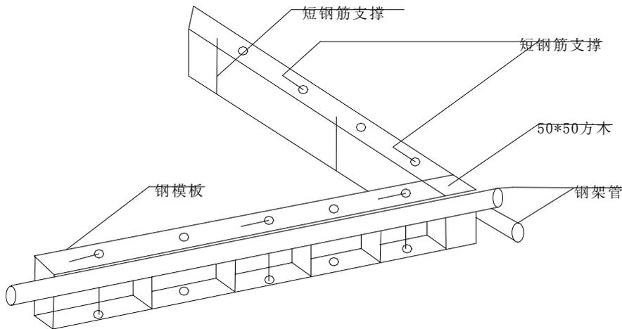
图 5-8 垫层混凝土模板
