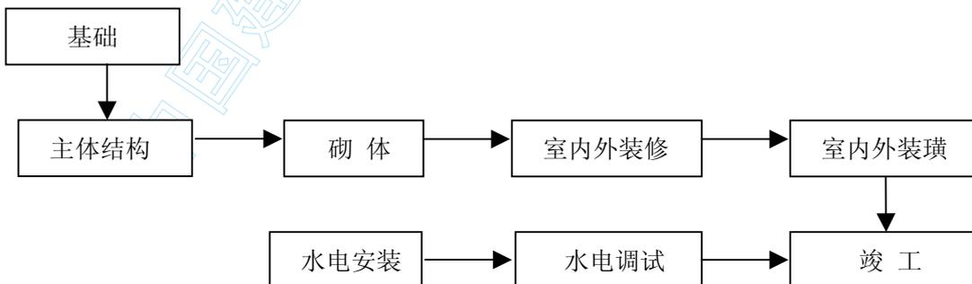
图 3-2 总体施工流程
