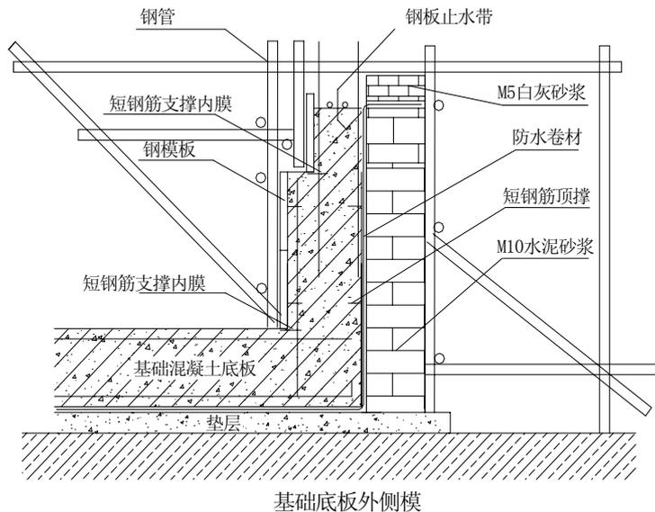
图 5-9 基础底板外侧混凝土模板图
