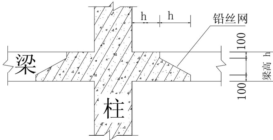
图 5-29 混凝土强度等级不同的节点施工措施
