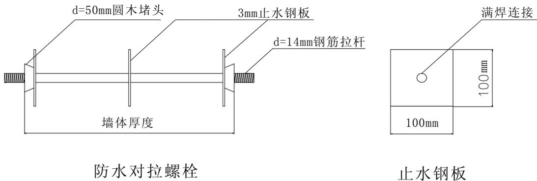
图 5-15 对拉螺栓示意图
