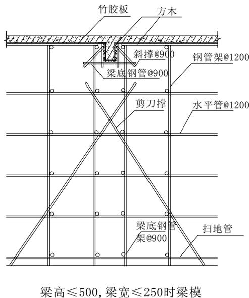
图 5-19 梁支模示意图一
