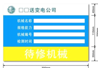
图 44 机械待修状态牌标准式样
