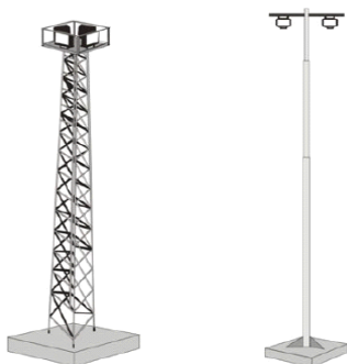
图 62 集中广式照明灯塔示例
