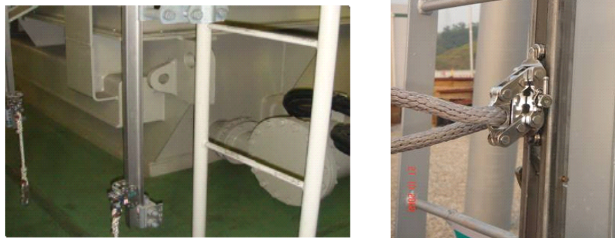
图 10 轨道式自锁器实物及应用实例
