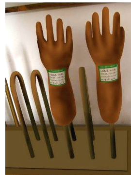
图 13 绝缘手套存放示意
