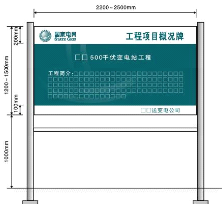
图 49 工程项目概况牌标准尺寸及内容示例
