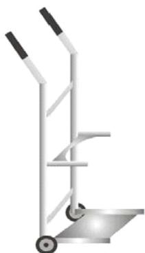
图 65 氧气\乙炔瓶搬运托架
