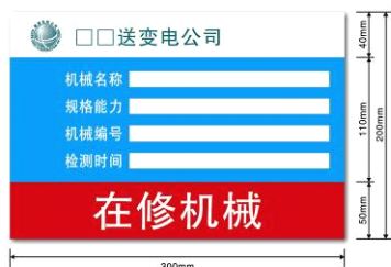
图 45 机械在修状态牌标准式样
