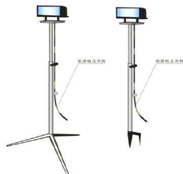
图 63 移动立杆式灯架示例
