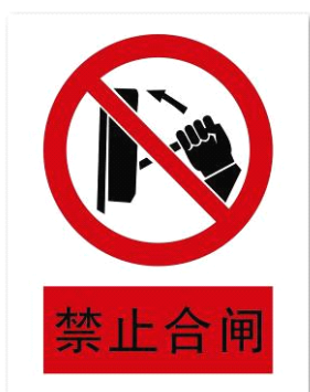
图 82 禁止合闸标志牌式样
