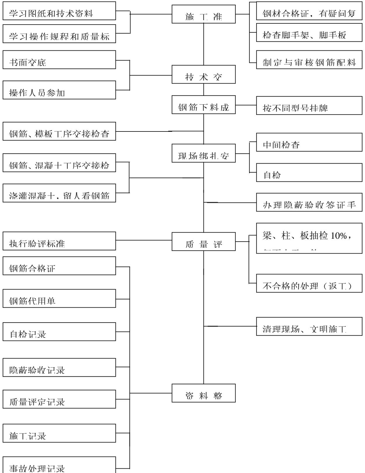
图 6-6 钢筋工程质量程序控制表
